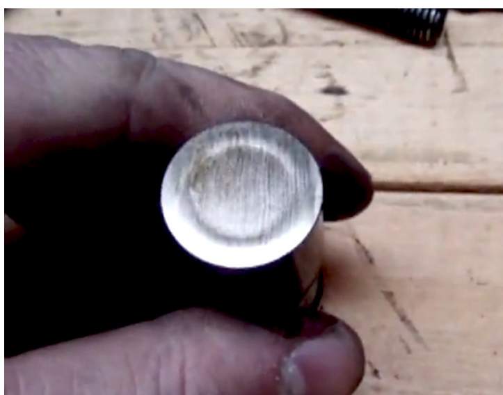
Zdj. 6. Wytarta płaszczyzna popychacza – najprawdopodobniej ten popychacz kwalifikuje się do wymiany.
