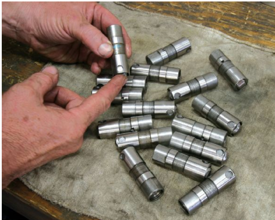
Zdj. 8. Tylko kompleksowa wymiana wszystkich popychaczy zaworów da nam pewność, że wyeliminujemy hałas.
