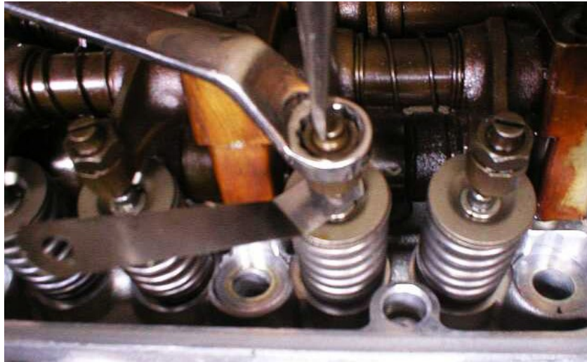
Zdj. 1. Mechaniczną regulację zaworów obecnie stosuje około 10 % producentów pojazdów (np. Honda, Toyota).
