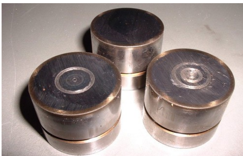
Zdj. 3. Hydrauliczne popychacze zaworów są niezwykle czule, na jakość oleju - wymagają jego regularnej wymiany.
