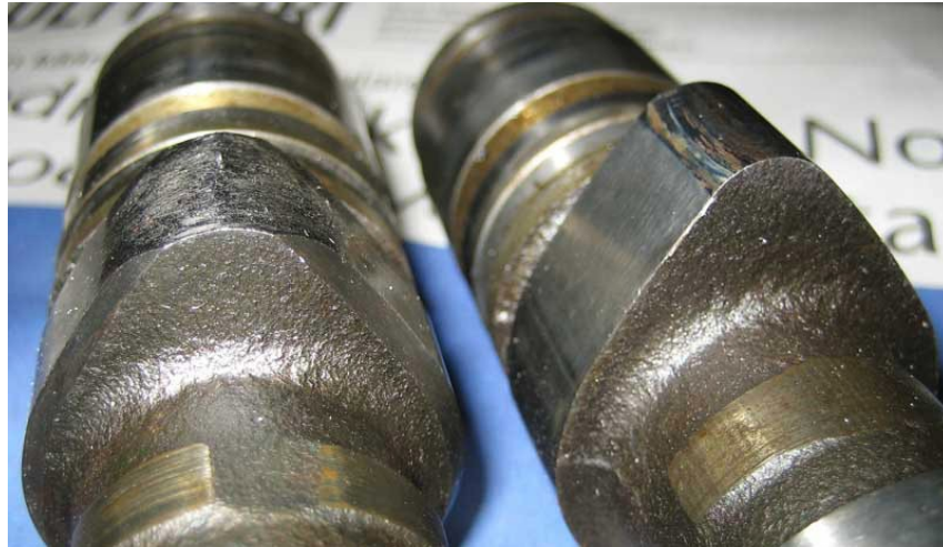
Zdj 4. Nieprawność hydraulicznych popychaczy zaworów może skutkować zużyciem krzywek wałków rozrządu.
