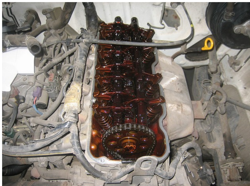
Zdj. 5. Hałas wydobywający się z okolicy pokrywy zaworów, może świadczyć o zużytych lub niesprawnych hydraulicznych popychaczach zaworów.
